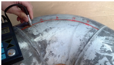
图7 管材壁厚测量位置
